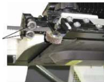
Rys. 3-6: Łożyska przewodzące taśmy
