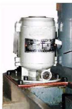
Rys. 6-5: Pompa cieczy chłodzącej B-40 GSM
