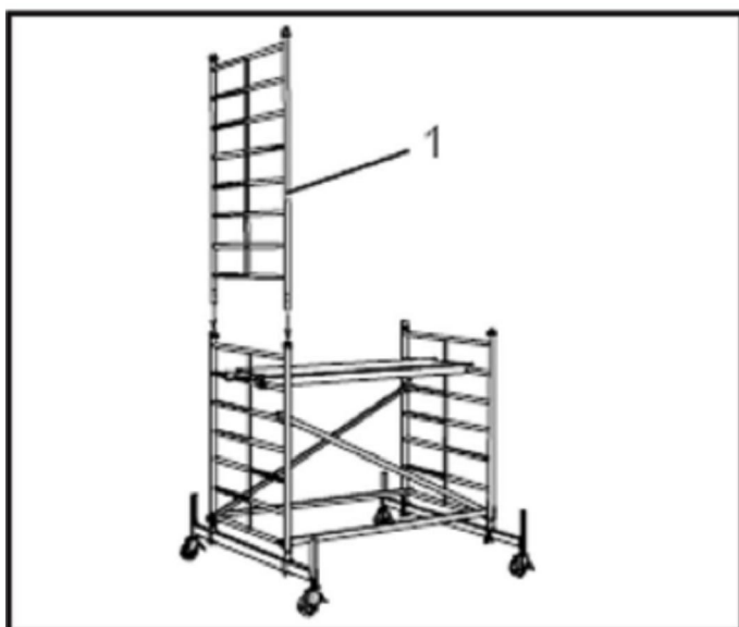
Rys. 25 Włożenie ramy nasadzanej
