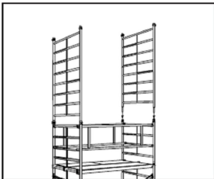
Rys. 34 Włożenie ramy nasadzanej
