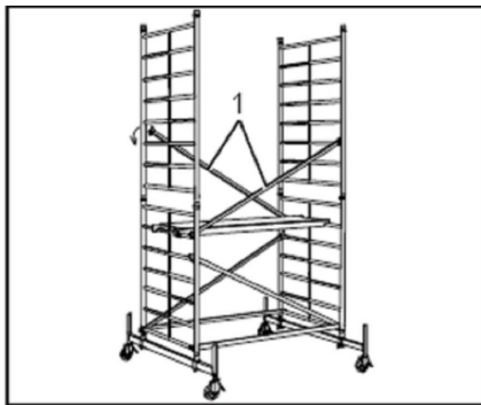
Rys. 27 Włożenie podpory diagonalnej
